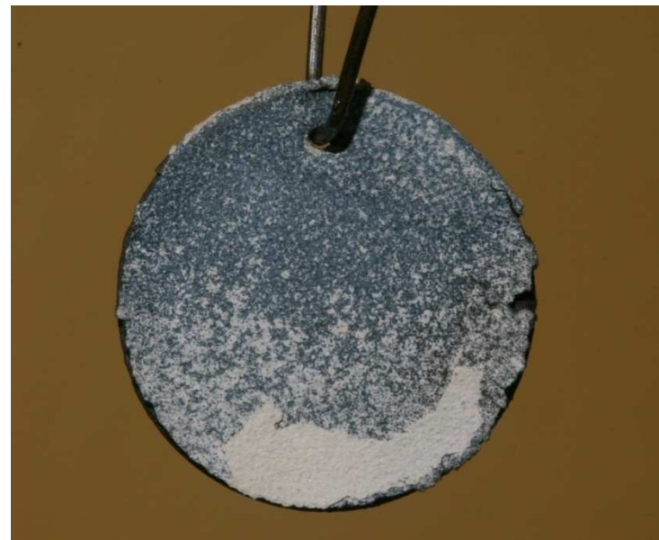
Próbka stali zaworowej poddanej utlenianiu w warunkach cyklicznych
